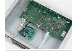
Unter dem Laufwerk verbergen sich die großen Platinen für die Signalverarbeitung
